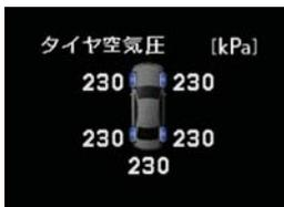
タイヤが装着されている位置ごとに、現在のタイヤ空気圧を表示します。
