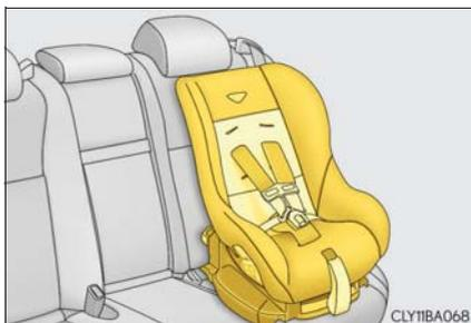
**4** フタを開けてトップテザーアンカーにフックを固定し、テザーベルトを締める
