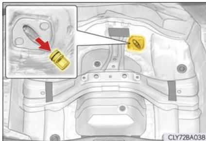
**7** 車載ドライバーのハンドルにパーキングブレーキ解除ツールを差しかえる
