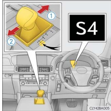
Sポジションへ操作したときの初期レンジは車速や走行状況に応じて3～6に設定されます。
