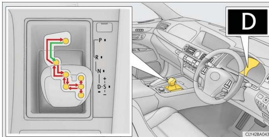
← エンジンスイッチがイグニッション ON モードの状態、ブレーキペダルを踏んだまま操作します。
