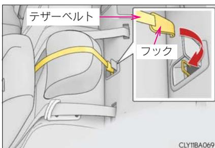
**5** 取り付けしたチャイルドシートを前後左右にゆすり、固定されていることを確認する
