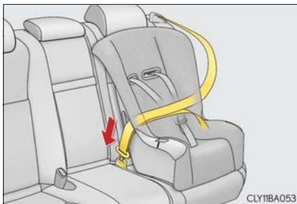
チャイルドシートにシートベルトの固定装置が備わっていない場合は、ロッククリップ（別売）を使用して固定する
