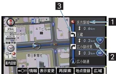
**1 案内ポイント** 分岐する交差点・IC・JCT 名称が表示されます。現在地から次に分岐する交差点・IC・JCTまでは、現在走行中の路線名が表示されます。
