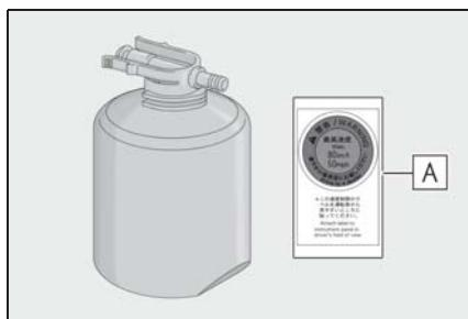
**A 速度制限ラベル****▶ コンプレッサー**
