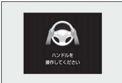
車線維持支援機能の作動中に、急カーブなどで曲がりきれず車線逸脱する可能性がある場合には表示による注意喚起を行い、運転者のステアリング操作をうながします。
