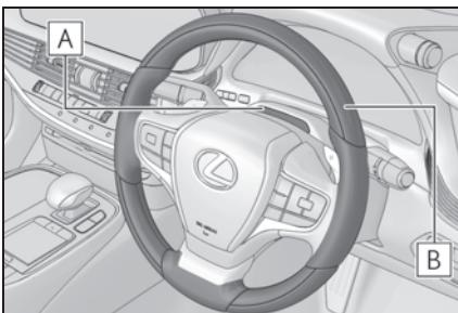
**A** ドライバーモニターカメラ**B** ステアリングセンサー
