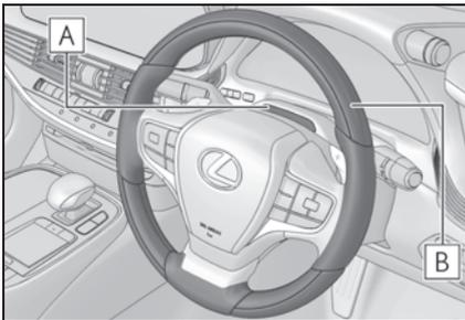
**A** ドライバーモニターカメラ**B** ステアリングセンサー
