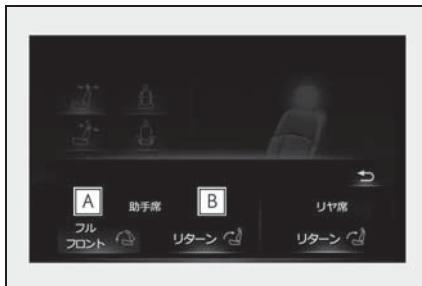
**A** 助手席を前方に移動し、背もたれとヘッドレストを前倒しにする
