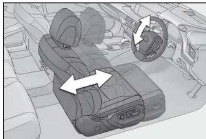
パワースイッチが OFF で、クッションの側面（クッションサイドサポート）★が中立位置にあるときに運転席ドアを開けると、クッションの側面が開きます。
