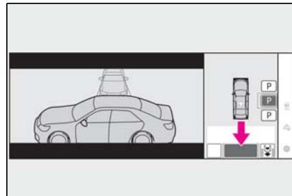
● ブレーキペダルを離すと、“前進します”または“後退します”的音声案内と表示が出たあと、前進・後退が始まります。
