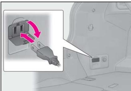
● 電源プラグが半挿しの状態にならないようにしてください。次の場合は、延長ケーブルなどを使用し、電源プラグを確実に接続してご使用ください。
