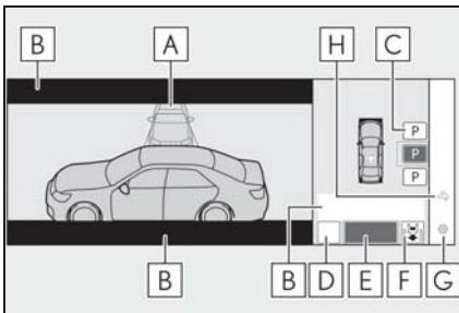
**A** 目標駐車枠（青色）**B** アドバイス表示**C** 駐車形態切り替えスイッチ
