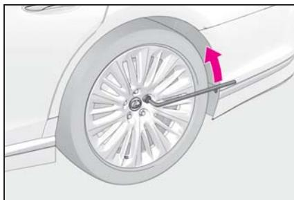
3 ジャッキのA部を手でまわして、ジャッキ溝をジャッキセット位置にしっかりとかける
