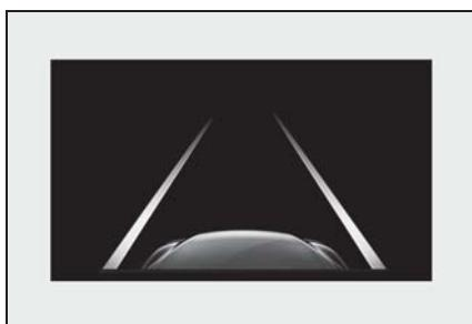
システムが白（黄）線または走路※を認識していることを示しています。車両が車線から逸脱した場合、逸脱している側の白線表示が橙色で点滅します。
