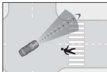
● 例えば次のような状況では、センサーが自車線、車両の回避スペースを検出できず、アクティブ操舵回避支援が作動しないおそれがあります。
