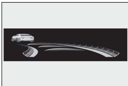
路面のカーブに応じて、ヘッドアップディスプレイに表示されます。
