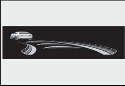
路面のカーブに応じて、ヘッドアップディスプレイに表示されます。
