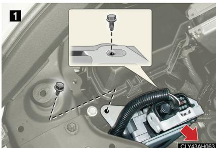
1 ECU ユニットの固定ボルトをはずし、ECU ユニートを移動する。
