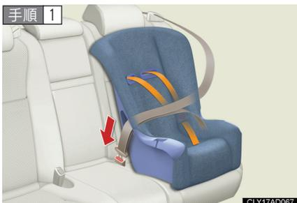
チャイルドシートにシートベルトを取り付け、プレートを保ックルに“カチッ”と音がするまで差し込む。ベルトがねじれていないようにする。
