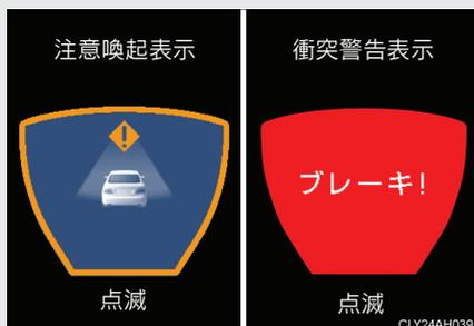
衝突の危険性があると検知したとき、“ピーピーピー”とブザー音が鳴り、PCS 警告灯が点滅し、マルチインフォメーションディスプレイに注意喚起表示が出ます。さらに衝突の可能性が高い場合には、“ピピピ…”とブザー音が鳴り、PCS 警告灯が点滅、衝突警告表示を出し、回避操作を促します。
