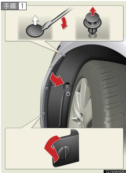
交換するライトの反対側へハンドルをまわし、タイヤの向きをかえる。フェンダーライナー固定ボルトとクリップをはずし、フェンダーライナーをめくる。
