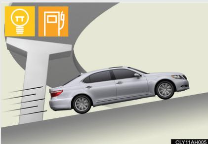
ガソリンエンジンに加え、駆動用電池からも電気モーターに電力を供給し、電気モーターの出力を上げ、力強く加速します。
