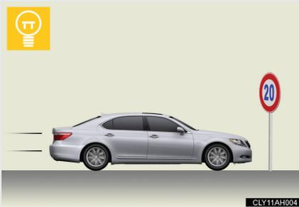
ガソリンエンジンの効率が悪い領域では、ガソリンエンジンを停止し、電気モーターで走行します。
