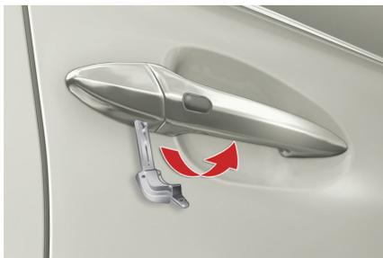
電子キーに内蔵されているメカニカルキーを使います。運転席側のドアハンドルのカバーを取りはずして操作します。
