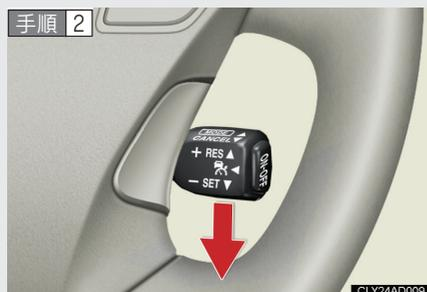
希望の速度（約 45km/h ～ 100km/h）まで加速 / 減速し、レバーを下げて速度を設定する
