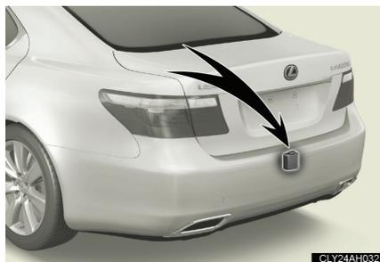
レーダーセンサーにより、後方から接近する物を検知し、その位置や速度、進路から追突する可能性を事前に判断します。
