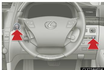
ブレーキペダルをしっかりと踏み、EV ドライブモードスイッチを押しながら POWER スイッチを押す。
