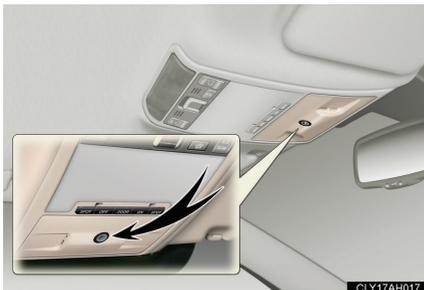
オートアラームが作動するとカメラが車内の様子を撮影します。詳しくは別冊「HDD ナビゲーションシステム取扱説明書 / G-Link サービス / G-Security」をご覧ください。
