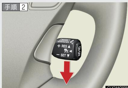
希望の速度まで加速 / 減速し、レバーを下げて速度を設定する
