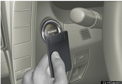
**手順 3** パワースイッチの切り替え：ブザーが鳴ってから 10 秒以内に、ブレーキペダルから足をはなしてパワースイッチを押します。パワースイッチを押すごとにスイッチを切り替えることができます。(→P. 150)
