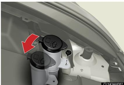
ウォッシャー液補給口の固定ボルトをはずし、補給口の位置を移動する。
