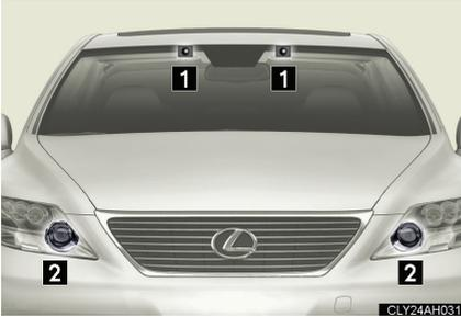
レーダーセンサーに比べ走行中に路上またはその付近の走行者など立体物を検知します。ヘッドライト点灯時には近赤外線を照射し、夜間の検出性能の確保に寄与します。
