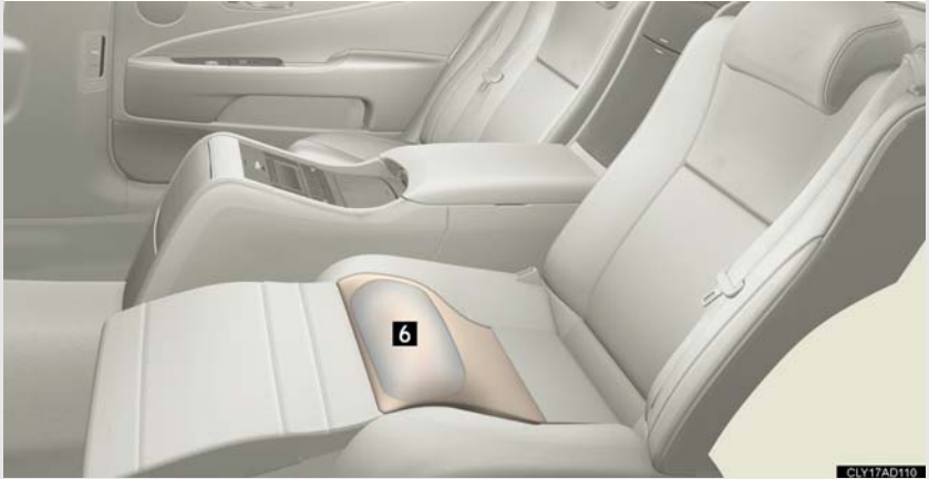
6 SRS シートクッションエアバッグ（4席車両リラクゼーションシートのみ） （リラクゼーションシート乗員の拘束に寄与）
