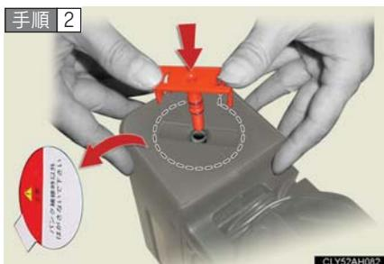
キット底面を上に向けてシールをはがし、差し込みパーツを押し込む。
