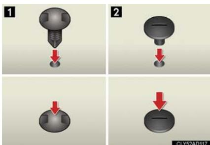
図のようにクリップを取り付ける。
