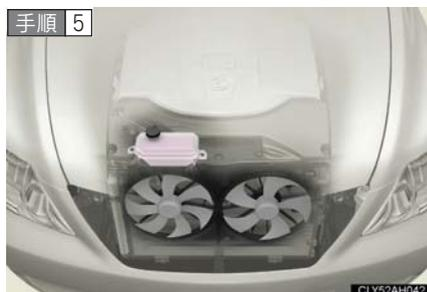
ハイブリッドシステムが十分に冷えてから、冷却水の量や冷却水漏れを点検する。
