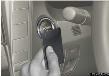
**手順 3** “パワー”スイッチの切り替え：ブザーが鳴ってから 10 秒以内に、ブレーキペダルから足をはなして“パワー”スイッチを押します。“パワー”スイッチを押すごとにスイッチを切り替えることができます。(→P. 155)
