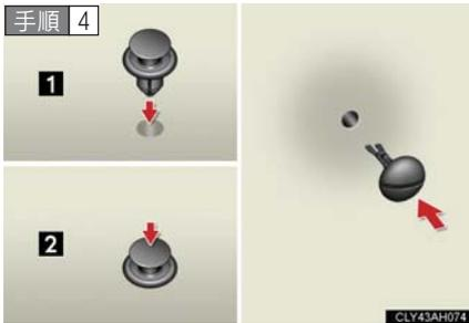
固定ボルトとクリップを取り付ける。
