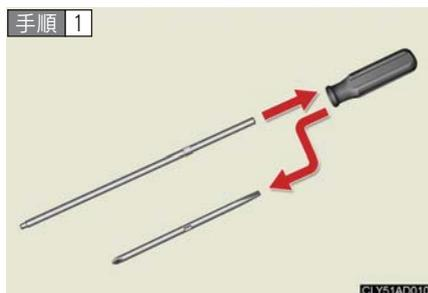
パーキングブレーキ解除ツールと車載ドライバーをトランクから取り出す。(→ P. 351)
