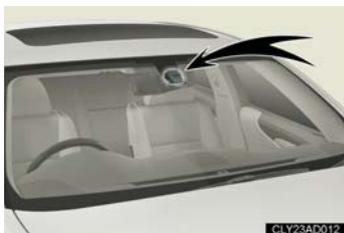
雨滴感知センサーが雨滴量を判定します。
