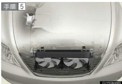
ハイブリッドシステムが十分に冷えてから、冷却水の量や冷却水漏れを点検する。
