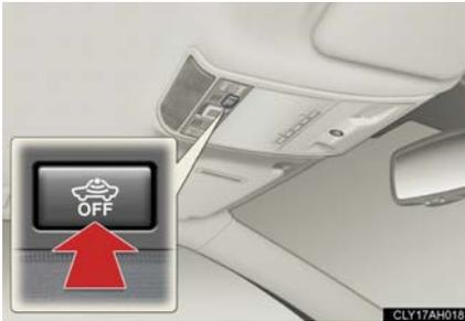
“パワー” スイッチを OFF にし、侵入センサー OFF スイッチを押す
