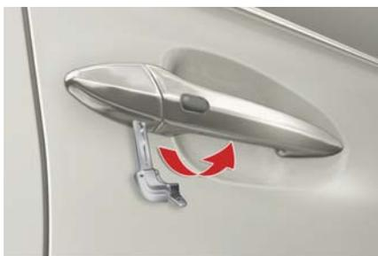
電子キーに内蔵されているメカニカルキー（→P. 49）を使います。運転席側のドアハンドルのカバーを取りはずして操作します。
