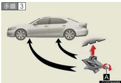
ジャッキの A 部を手でまわして、ジャッキ溝をジャッキセット位置にしっかりかける。
