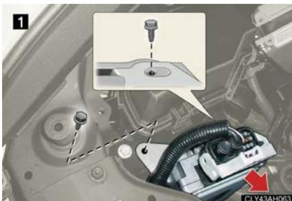
1 ECUユニットの固定ボルトをはずし、ECUユニットを移動する。
