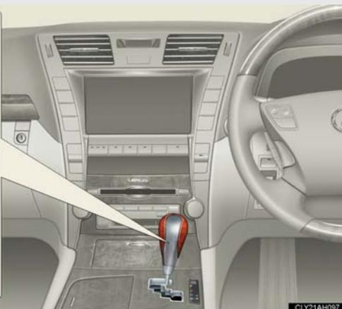
← “パワー” スイッチが ON モードの状態、ブレーキペダルを踏んだまま操作します。
