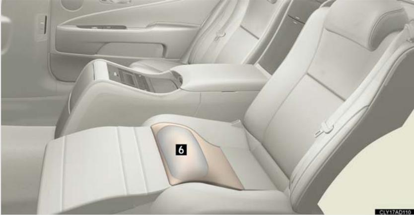
**6** SRS シートクッションエアバッグ（4席車両リラクゼーションシートのみ）
