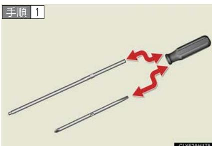
パーキングブレーキ解除ツールと車載ドライバーをトランクから取り出す。(→ P. 361)
