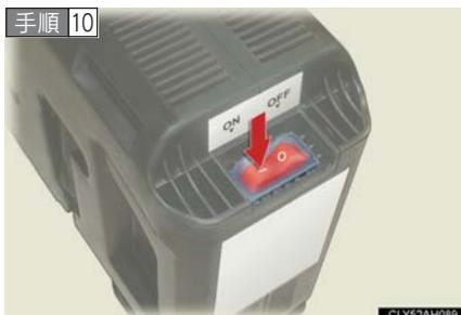
キットのスイッチを ON にし、パンク補修液と空気を充填する。
