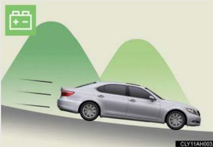
車輪が電気モーターを発電機として動かし、駆動用電池へ充電します。(回生ブレーキ)
