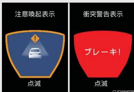
衝突の危険性があると検知したとき、“ピーピーピー”とブザー音が鳴り、PCS 警告灯が点滅し、マルチディスプレイに注意喚起表示が出ます。さらに衝突の可能性が高い場合には、“ピピピ…”とブザー音が鳴り、PCS 警告灯が点滅、衝突警告表示を出し、回避操作を促します。
