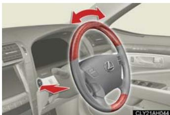
マルチディスプレイにメッセージが表示され、“パワー”スイッチ上のインジケーターが緑色に点滅します。ハンドルを左右にまわしながら再操作してください。
