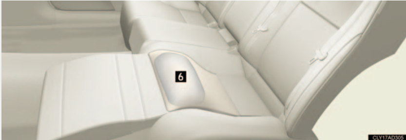
6 SRS シートクッションエアバッグ（リラクゼーションシートのみ） （リラクゼーションシート乗員の拘束に寄与）
