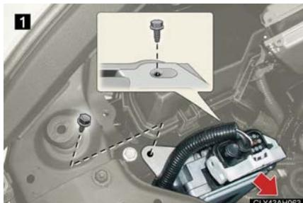
① ECU の固定ボルトをはずし、ECU を移動する。
