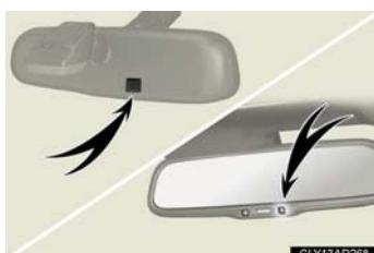
センサーの誤作動を防ぐため、センサーに触れたりセンサーを覆つたりしないでください。
