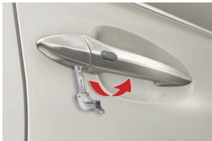
電子キーに内蔵されているメカニカルキー（→P. 52）を使います。運転席側のドアハンドルのカバーを取りはずして操作します。
