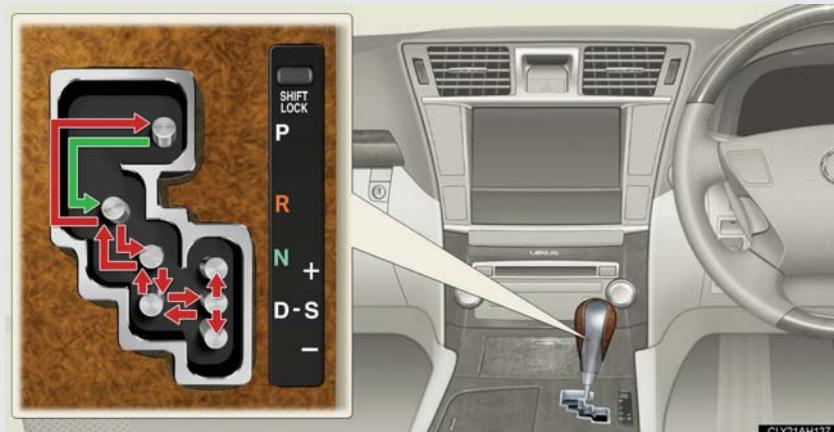
◀ “パワー”スイッチがONモードの状態で、ブレーキペダルを踏んだまま操作します。
