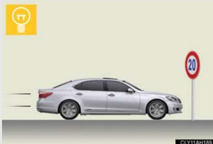
ガソリンエンジンの効率が悪い領域では、ガソリンエンジンを停止し、電気モーターで走行します。
