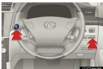
ブレーキペダルをしっかりと踏み、EV ドライブモードスイッチを押しながら“パワー”スイッチを押す。
