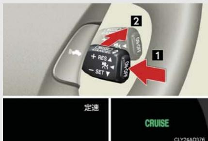
① ON-OFF スイッチでシステムを ON にする
