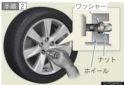
タイヤを取り付け、タイヤがたつかない程度まで手でナットを仮締めする。
