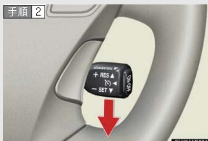
希望の速度まで加速／減速し、バーを下げる設定する。
