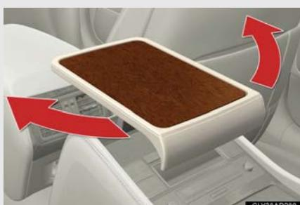
テーブルの向きを変えることができます。テーブルを使用する前に、必ずロックされている事を確認してください。
