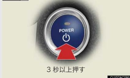
“パワー”スイッチを 3 秒以上押し続けてハイブリッドシステムを停止する。
