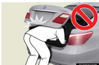
● 半開状態で使用すると、トランクリッドが落ちて重大な傷害を受けるおそれがあります。とくに傾斜地では、平坦な場所よりもトランクの開閉がしにくく、急にトランクが開いたり閉じたりするおそれがあります。必ずトランクが全開で静止していることを確認して使用してください。
