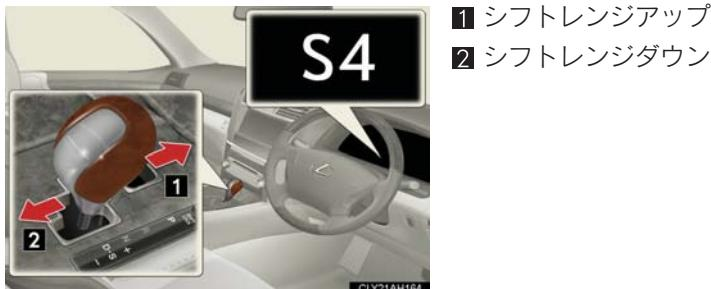
S ポジションへ操作したときの初期シフトレンジは車速に応じて 4、5、6 レンジもしくは 7 レンジに設定されます。
