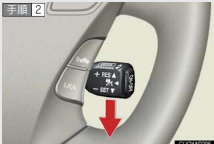
希望の速度（約 50km/h ～ 100km/h）まで加速 / 減速し、レバーを下げるで速度を設定する。
