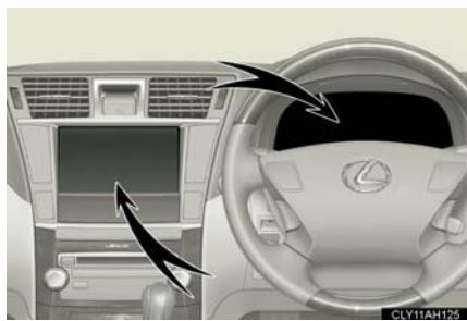
車両駆動状況、ハイブリッド動作状況およびエネルギーの回収状況を表示します。ナビゲーションシステムの画面とメーター内のマルチインフォメーションディスプレイで表示させることができます。
