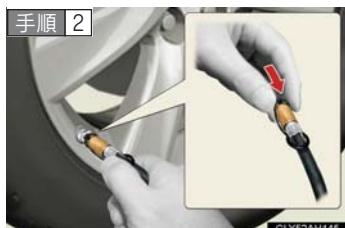
ホース先端に空気逃がしキャップをかぶせ、キャップの突起部をバルブに押しあて、空気を抜く。
