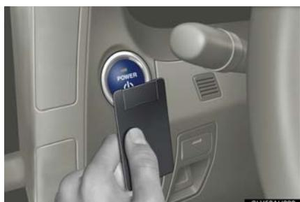
**手順 3]** “パワー” スイッチの切り替え：ブザーが鳴ってから 10 秒以内に、ブレーキペダルから足をはなして “パワー” スイッチを押します。“パワー” スイッチを押すごとにスイッチを切り替えることができます。( $\rightarrow$ P. 170)
