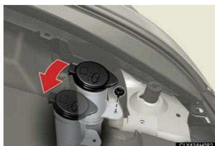
ウォツシヤー液補給口の固定ボルトをはずし、補給口の位置を移動する。
