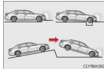
■SRS エアバッグが作動しないとき（フロント SRS エアバッグ、SRS シートクッションエアバッグ）
