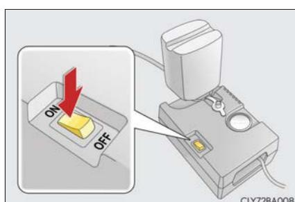
**13** 空気圧が指定空気圧になるまで充填する
