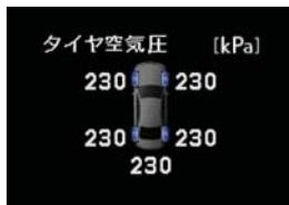
タイヤが装着されている位置ごとに、現在のタイヤ空気圧を表示します。
