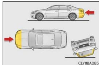
SRS カーテンシールドエアバッグは、後方からの衝撃・横転・または低速での前方や側面からの衝撃で作動するようには設計されていません。
