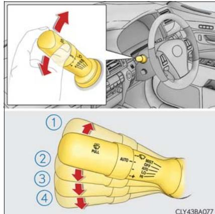
雨滴感知オート作動のときは、次のようにツマミをまわして、雨滴センサーの感度を調整できます。
