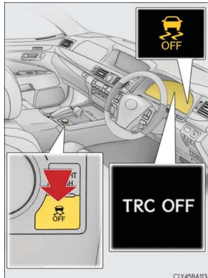
※ PCS（プリクラッシュセーフティシステム）装着車は、警報ブレーキ・プリクラッシュブレーキアシスト・プリクラッシュブレーキも停止します。PCS 警告灯が点灯し、マルチインフォメーションディスプレイに「VSC が OFF のためプリクラッシュブレーキも停止します」と表示されます。（→ P. 273）
