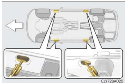
鎖やケーブルなどを使用して車両を固縛する場合は図に黒く示す角度が $45^{\circ}$  になるように固縛する
