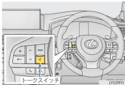
**1** ステアリングスイッチのトーカススイッチを押し続ける。
