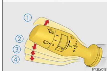
“AUTO”が選択されているときは、次のようにツマミをまわして雨滴センサーの感度を調整できます。
