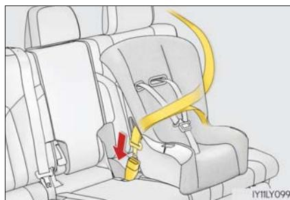
チャイルドシートにシートベルトの固定機構が備わっていない場合は、ロッキングクリップ(別売)を使用して固定する
