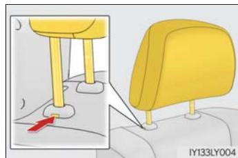
**② マイナスドライバーを挿し込みながらヘッドレストを引き抜く**
