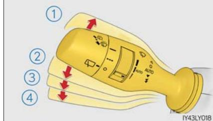
“AUTO”が選択されているときは、次のようにツマミをまわして雨滴センサーの感度を調整できます。
