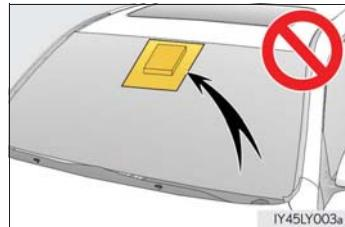
● カメラセンサー前部のフロントウインドウガラスが曇ったり、結露したり、凍結したりした場合は、フロントデフロスターで取り除く（→ P. 378）
