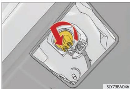
**3** 電球を取りはずす
