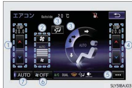
リモートタッチのタッチパッドを操作して画面上のスイッチを選択し、タッチパッドを押すまたは、ダブルタップ（軽く2回たたく）で決定します。
