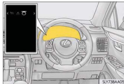
**6** メーター操作スイッチの ▲ または ▼ を押し、TPMS 画面を選択し [ ] を長押しする
