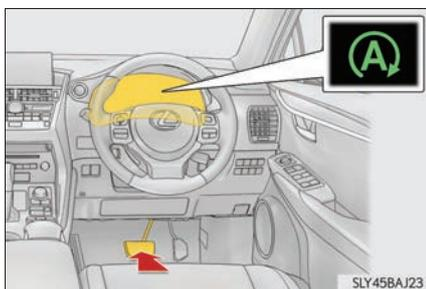
シフトレバーをDまたはMで走行中、ブレーキペダルを踏み車両を完全に停止させると、エンジンが自動的に停止する
