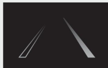
システムが白（黄）線または走路※<sup>1</sup>を認識していることを示しています。車両が車線から逸脱した場合、逸脱している側の白線表示が橙色で点滅します。
