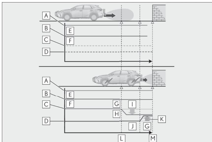
**A** アクセルペダル**B** ブレーキペダル**C** エンジン出力**D** 制動力**E** ON
