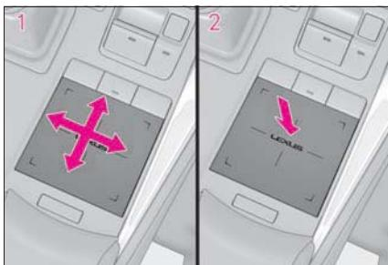
**1 選択する：**タッチパッドを操作して、ポインタ<sup>※</sup>をスイッチに合わせる
