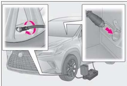
**21** コンプレッサーのスイッチを ON にして数秒間経過後、スイッチを OFF にして空気圧を確認する
