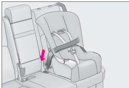
4 チャイルドシートにシートベルトの固定装置が備わっていない場合は、ロッキングクリップ (別売) を使用して固定する
