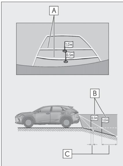
**A 距離目安線****B 実際の距離****C 誤差****車が傾いているとき**
