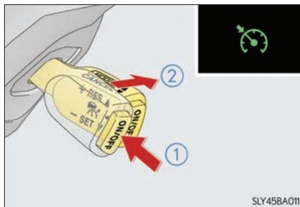
定速制御モードに切りかえると、クルーズコントロール表示灯が点灯します。定速制御モードから車間制御モードにもどすには、再度レバーを前方に約 1 秒間押し続けます。
