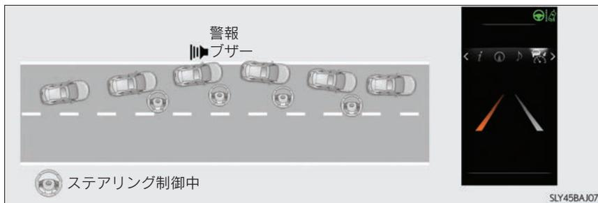
車両が車線から逸脱するとシステムが判断した場合に、マルチインフォメーションディスプレイ表示および、ステアリング制御によりハンドルに操舵力を与え、車線逸脱の回避に必要なハンドル操作の一部を支援します。
