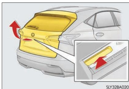
**車外からバックドアを閉じるには（パワーバックドア装着車）****スイッチを押す**
