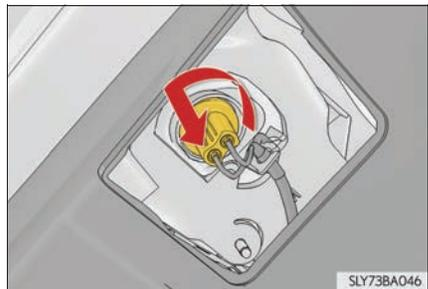
**3** 電球を取りはずす
