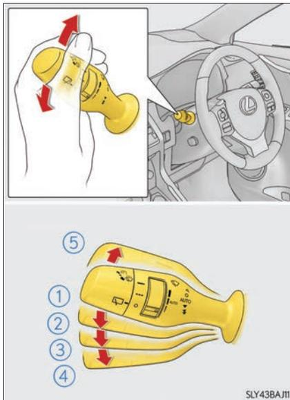
“AUTO” が選択されているときは、次のようにツマミをまわして、雨滴センサーの感度を調整できます。
