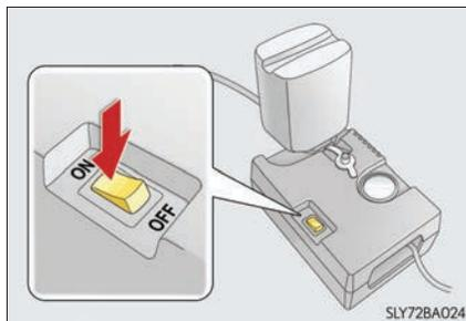
**14** 空気圧が指定空気圧になるまで充填する
