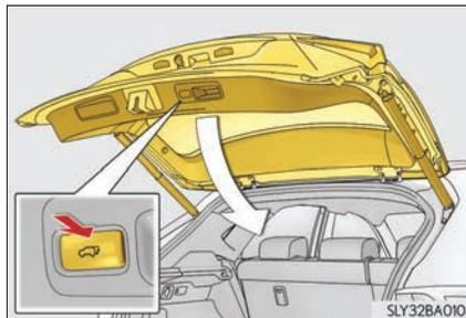
**バックドアを閉めるときは****▶ パワーバックドア非装着車**
