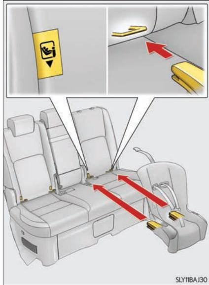
**4** 取り付けしたチャイルドシートを前後左右にゆすり、固定されていることを確認する
