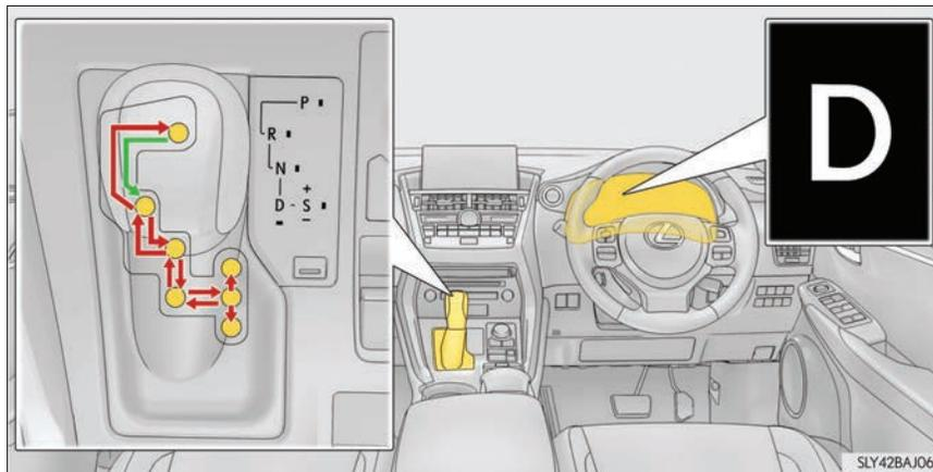
← パワースイッチが ON モードの状態、ブレーキペダルを踏んだまま操作します。
