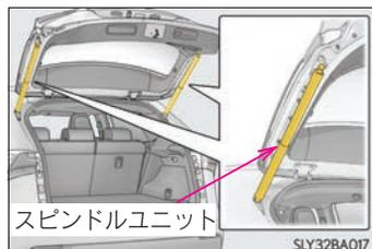
■ バックドアアイジークローザーの故障を防ぐために（パワーバックドア装着車）
