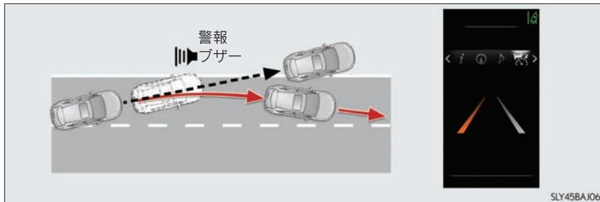
車両が車線から逸脱するとシステムが判断した場合に、警報ブザーが「ピピピピ」と鳴り、マルチインフォメーションディスプレイの表示により注意をうながします。
