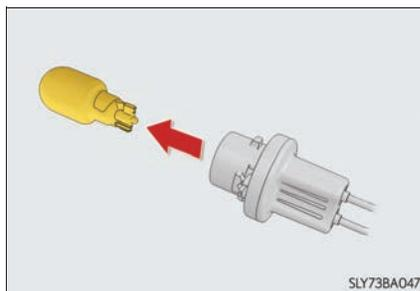
**4** 電球を交換しソケットを取り付ける
