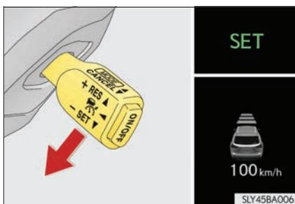
車速が約 50km/h 未満で先行車が検知できるときに操作をすると、設定速度を 50km/h として先行車に追従走行をします。
