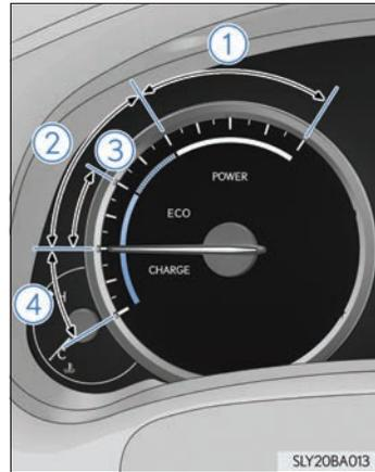
●ハイブリッドシステムインジケータは、ドライブモードがノーマルモードまたはエコドライブモードのときに表示されます。（→ P. 267）
