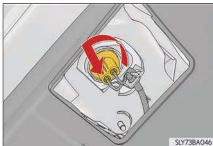
**3** 電球を取りはずす
