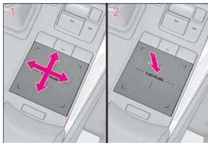
**1** 選択する：タッチパッドを操作して、ポインタ<sup>※</sup>をスイッチに合わせる
