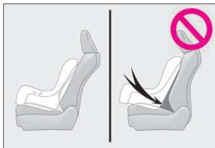
※3ヘッドレストとチャイルドシートが干渉してチャイルドシートが正しく取り付けられない場合、ヘッドレストの取りはずしが可能なときは、ヘッドレストを取りはずしてください。
