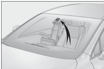
● パワースイッチが ON モードのときにワイパースイッチを **AUTO** にすると、動作確認のためワイパーが1回作動します。
