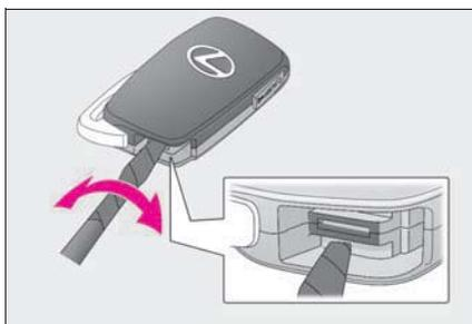
傷が付くのを防ぐため、マイナスドライバーの先端に布などを巻いて保護してください。
