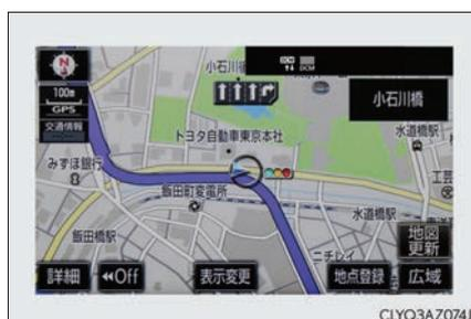
マップオンデマンド (地図更新サービス) は、通信またはパソコンを使って車載機の地図データを更新するサービスです。通信による自動更新では、アクセサリモードまたは ON モード時ならびに目的地設定時にセンターへアクセスし、新しい地図データがあれば自動的にダウンロードします。
