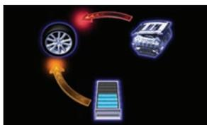
マルチインフォメーションディスプレイでは、エネルギーの流れを矢印の動きで表示します。
