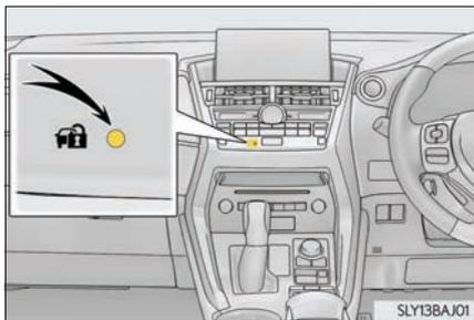
パワースイッチを OFF にすると、システムの作動を知らせるためにセキュリティ表示灯が点滅します。
