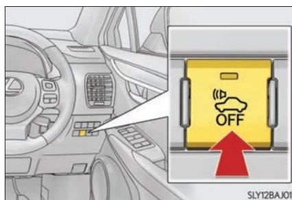
消音するには、READY インジケーターが点灯している状態で、スイッチを押す
