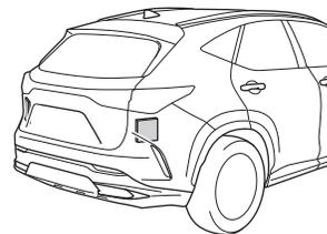
後方にある作動対象を検知して音や画面で知らせたりドアの開放をキャンセルしたりして安全な降車を支援する
