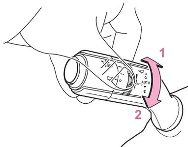
AUTO が選択されているときは、ツマミをまわして、雨滴センサーの感度を調整できます。
