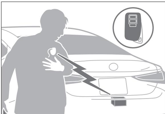
スマートエントリー&スタートシステムは、電子キーと車のアンテナとの間で微弱な電波の送受信を行っています。スマートエントリー&スタートシステムの電波は、医療用の電気機器に影響を及ぼすおそれがあります。次のように対応してください。
