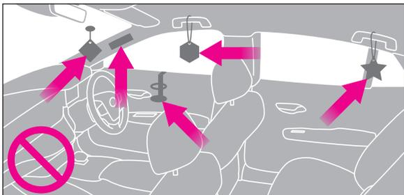
SRSエアバッグが展開する次のような部位に何かを付けたり、置いたり、かけたりしないでください。SRSエアバッグが正常に作動するのをさまたげ、システムが作動しない、または誤って作動するおそれがあります。
