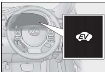
ガソリンエンジン停止中や、電気モーターのみで走行しているときに、EV インジケーターが点灯します。
