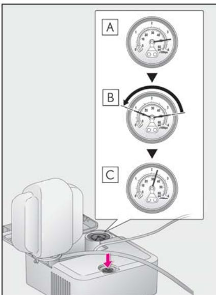
**A** スイッチ ON 直後は、パンク補修液を注入するため、一時的に空気圧計が上昇する
