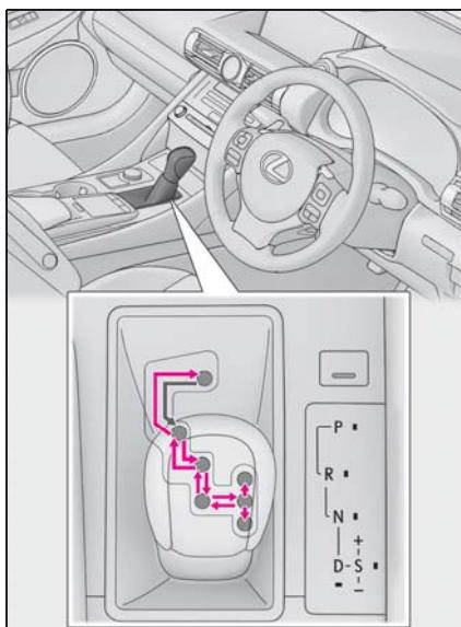
◀ パワースイッチがONモードの状態で、ブレーキペダルを踏んだまま操作します。
