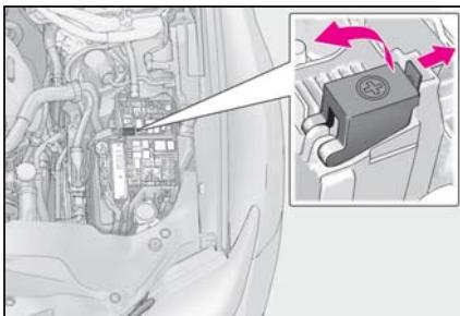
**4 赤色のブースターケーブルを自車の救援用端子**A**につなぎ、もう一方の端を救援車のバッテリーの+端子**B**につなぐ。その後、黒色のブースターケーブルを救援車のバッテリーの-端子**C**につなぎ、もう一方の端を、未塗装の金属部（図に示すような固定された部分）**D**につなぐ**
