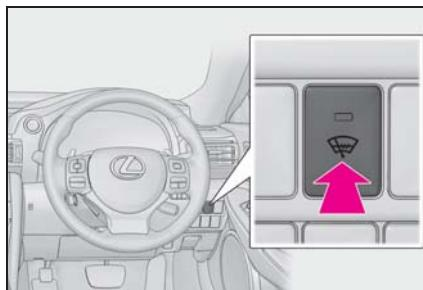
ウィンドシールドデアイサーが ON のとき、スイッチの作動表示灯が点灯します。
