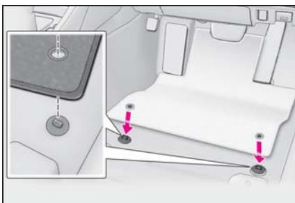
**2 固定フック（クリップ）上部のレバーをまわして、フロアマットを固定する**
