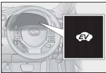
ガソリンエンジン停止中や、電気モーターのみで走行しているときに、EV インジケーターが点灯します。
