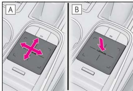
**A** 選択する：タッチパッドを操作して、ポインタ※をスイッチに合わせる
