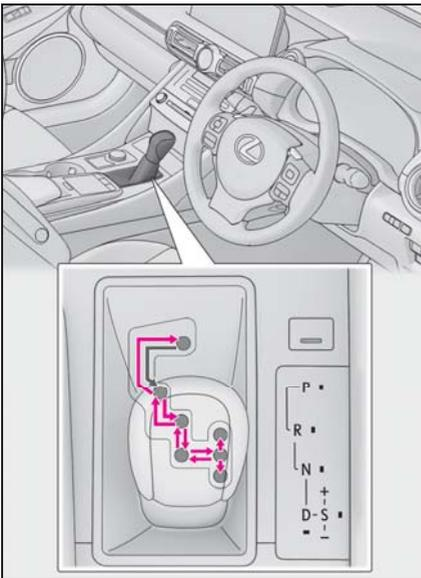
← パワースイッチが ON モードの状態では、ブレーキペダルを踏んだまま操作します。
