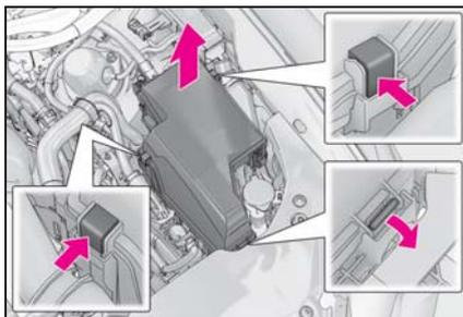
カバーを取り付けるときは、手前のプレートおよび左右のツメが確実にかみ合っていることを確認してください。
