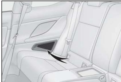
リヤシート横部には、駆動用電池冷却用の吸入口があります。吸入口をふさいだりすると、駆動用電池の過熱や出力低下の原因となります。
