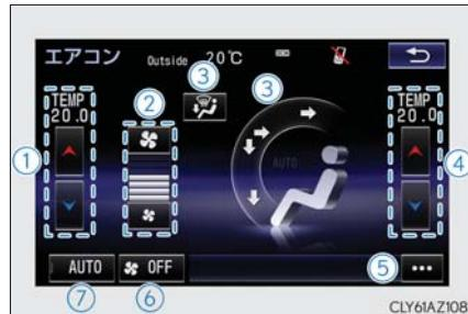
リモートタッチを操作して画面上のスイッチを選択し、リモートタッチパッドを押す
