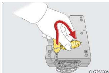
**7** コンプレッサーの電源プラグをアクセサリーソケットに挿し込む
