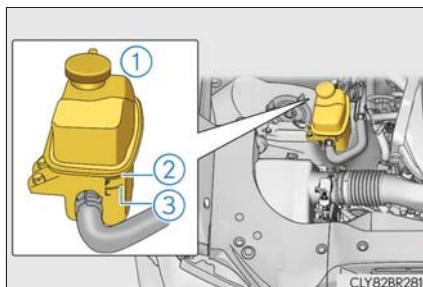
**5 冷却水が不足している場合は、冷却水を補給する**
