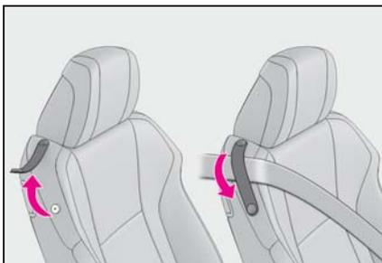
フロント席のシートベルトを着用するときは、ベルトをガイドに通してください。フロント席のシートベルトをガイドに通しておくことでシートベルトが引き出しやすくなります。
