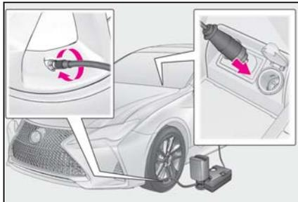
**20** コンプレッサーのスイッチをONにして数秒間経過後、スイッチをOFFにして空気圧を確認する
