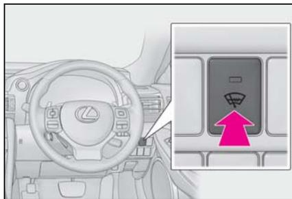
ウインドシールドデアイサーが ON のとき、スイッチの作動表示灯が点灯します。
