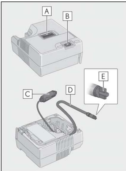
**A 空気圧計****B 電源スイッチ****C 電源プラグ****D ホース****E 空気逃がしキャップ****□ 知識****■ 応急修理キットについて**
