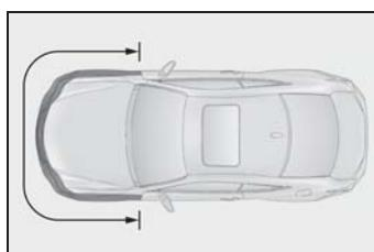
● SRS サイド & カーテンシールドエアバッグはふくらまなかつたが、事故でドアおよびその周辺部分を衝突したとき、または破損・変形などがあるとき
