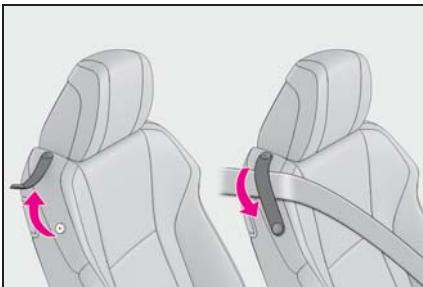
フロント席のシートベルトを着用するときは、ベルトをガイドに通してください。フロント席のシートベルトをガイドに通しておくとシートベルトが引き出しやすくなります。
