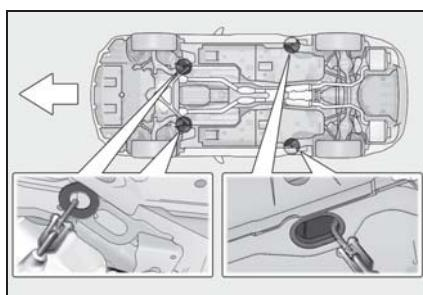
鎖やケーブルなどを使用して車両を固縛する場合は図に黒く示す角度が
