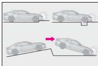
■ SRS エアバッグが作動しないとき（フロント SRS エアバッグ）
