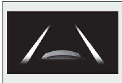
システムが白（黄）線または走路<sup>※</sup>を認識していることを示しています。車両が車線から逸脱した場合、逸脱している側の白線表示が橙色で点滅します。
