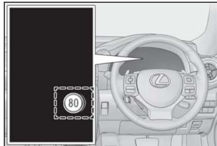
速度制限標識以外を認識した場合、速度標識の重複表示にてお知らせします。
