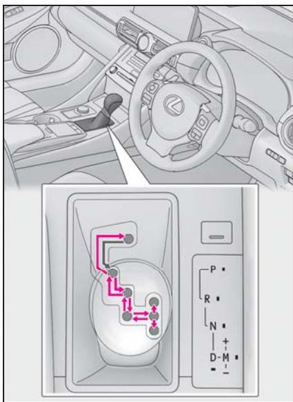
← エンジンスイッチがイグニッション ON モードの状態、ブレーキペダルを踏んだまま操作します。P と D のあいだの操作は、ブレーキペダルを踏み、車を完全に止めてから行ってください。
