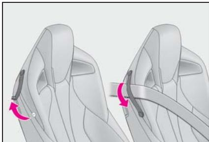
フロント席のシートベルトを着用するときは、ベルトをガイドに通してください。フロント席のシートベルトをガイドに通しておくことでシートベルトが引き出しやすくなります。
