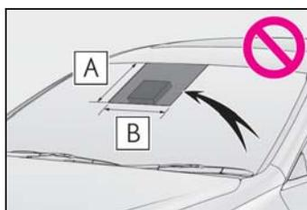
**A** フロントウィンドウガラス上端から前方カメラ下端より下約 1cm まで
