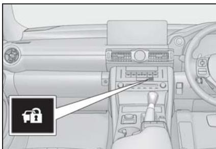
エンジンスイッチを OFF にすると、システムの作動を知らせるためにインジケーターが点滅します。
