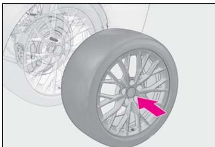
**3** 手または、ホイールボルトソケット **A** を使用し、ホイールボルトを軽く締め付ける
