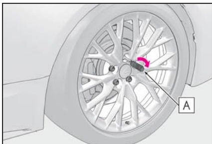
**4** ガイドピンを取り外し、ホイールボルトを手順 **3** 同様に軽く締め付ける
