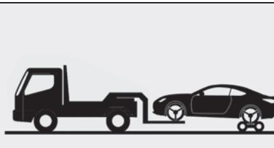
台車を使用して後輪を持ち上げる
