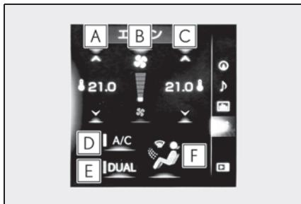
**A 助手席側の温度を調整する****B 風量を切りかえる****C 運転席側の温度を調整する****D 冷房・除湿する**
