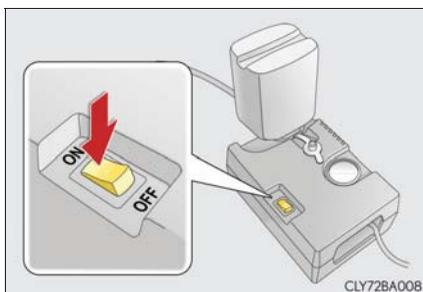
**13** 空気圧が指定空気圧になるまで充填する
