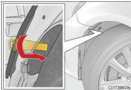
**4** 電球を取りはずす
