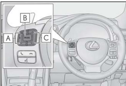
**A** コンテンツの読み上げ音量を調整する。
