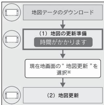
※ “地図更新”を選択しなかつた場合、次回エンジンスイッチ <パワースイッチ>をアクセサリーモードまたはイグニッションONモード<ONモード>時に地図更新を行います。
