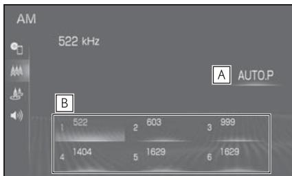
**A** 選択し続けると、自動で受信可能な周波数をプリセットスイッチに記憶します。再度選択すると、解除されます。
