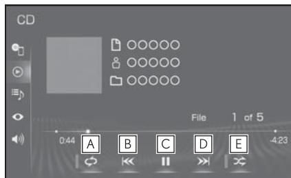
**A** 選択するたびに、再生中のファイルをリピート再生 → 再生中のフォルダをリピート再生 → リピート解除の順に切り替わります。
