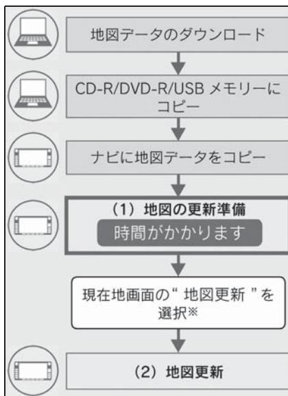
※ “地図更新”を選択しなかった場合、次回エンジンスイッチくパワースイッチをアクセサリーモードまたはイグニッションONモードくONモード時に地図更新を行います。
