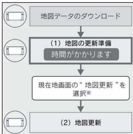
※ “地図更新”を選択しなかった場合、次回エンジンスイッチくパワースイッチをアクセサリーモードまたはイグニッションONモードくONモード時に地図更新を行います。
