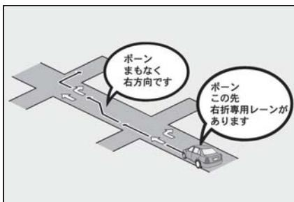
直進する交差点に右折（左折）専用レーンがある場合、その交差点に近づくと「この先 右折（左折）専用レーンがあります」と音声案内されます。目的地案内中で、右折（左折）する交差点では右折・左折専用レーン案内はされません。この場合は「ポン まもなく右方向（左方向）です」と音声案内されます。
