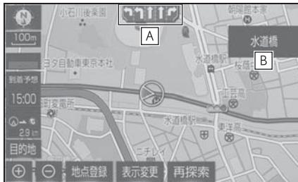
**A** 通過・分岐する交差点のレーンが表示されます。
