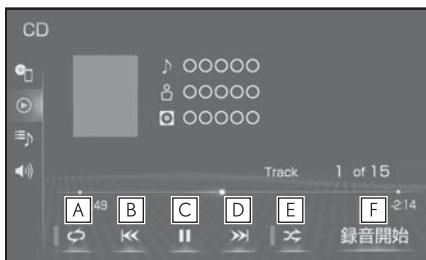
**A** 選択するたびに、再生中のトラックをリピート再生 → リピート解除の順に切り替わります。
