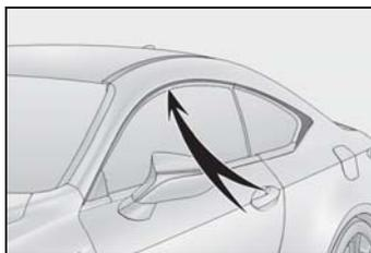
図で示す部品には、黒色ステンレスの表面処理を施しています。
