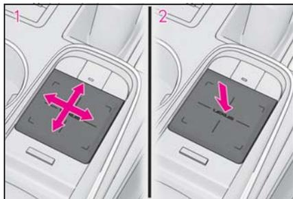
1 選択する：タッチパッドを操作して、ポインタ※をスイッチに合わせる
