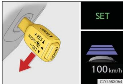
车速が約 50km/h 未満、かつ先行車がいる状態でレバーを操作したときは、設定速度が約 50km/h にセットされます。
