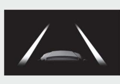
システムが白（黄）線または走路<sup>※</sup>を認識していることを示しています。車両が車線から逸脱した場合、逸脱している側の白線表示が橙色で点滅します。
