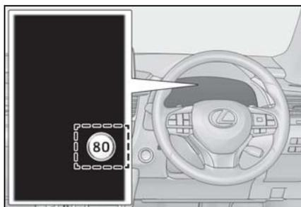
速度制限標識以外を認識した場合、速度標識の重複表示にてお知らせします。
