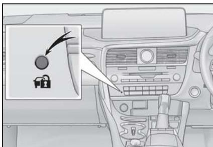
エンジンスイッチを OFF にすると、システムの作動を知らせるためにセキュリティ表示灯が点滅します。
