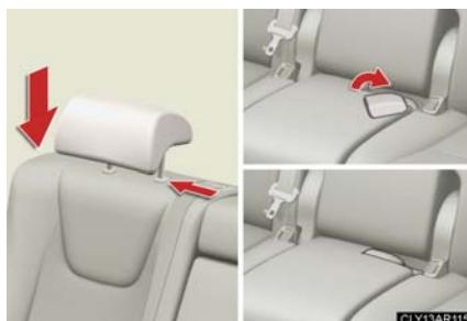
ヘッドレストとセンターシートのシートベルトバックルを格納する
