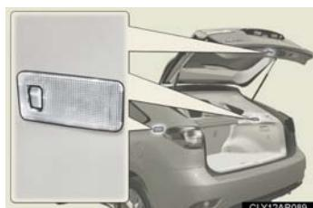
スイッチをONにしておくとバックドアを開けたとき、ラゲージルームライトが点灯します。
