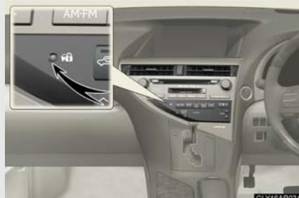
ドア・ボンネットを閉め、スマートエントリー＆スタートシステム、ワイヤレスリモコンを使って施錠します。30 秒以上経過すると、自動的に設定されます。
