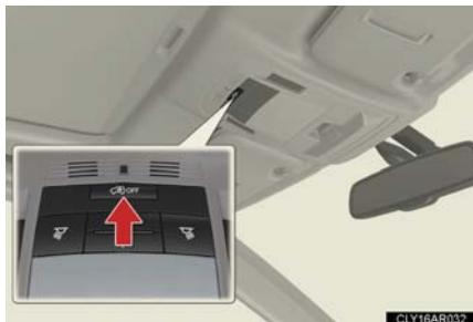
“エンジン スタート ストップ”スイッチを OFF にし、侵入センサー OFF スイッチを押す
