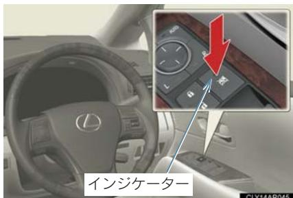
スイッチを押すと、インジケーターが点灯し、運転席以外のドアガラスが作動不可になります。
