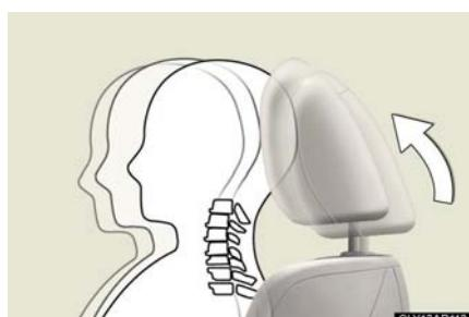
追突の衝撃によって、乗員の腰がシートバックを押すことでのヘッドレストが少し斜め上方に動き乗員のむち打ち傷害軽減に貢献します。
