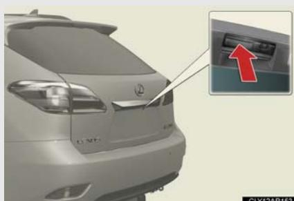
バックドア解錠時：バックドアオープンスイッチを押す
