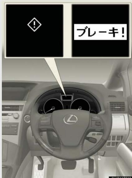
衝突の可能性があると検知したとき、“ピーピーピー”とブザー音が鳴り、マルチインフォメーションディスプレイに注意喚起表示が出ます。さらに衝突の可能性が高い場合には、“ピピピ…”とブザー音が鳴り、PCS 警告灯が点滅、衝突警告表示を出し、回避操作をうながします。
