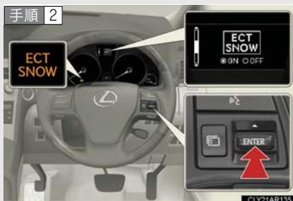
“ENTER”スイッチを押して、ONに切りかえると“ECT SNOW”表示灯が表示されます。
