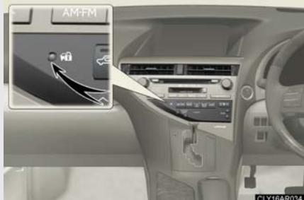
“エンジン スタート ストップ”スイッチを OFF になると、システムの作動を知らせるためにインジケーターが点滅します。
