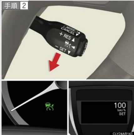
希望の速度まで加速 / 減速し、レバーを下げる速度を設定する
