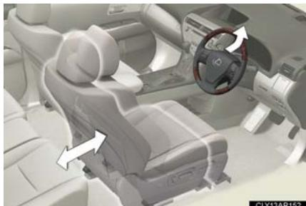
降車時：以下のすべての操作を行ったとき、ハンドルが最上段・最前方に移動、運転席シートが後方に移動（オートアウエイ機能）
