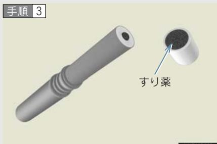
先端のフタを取り、すり薬で発炎筒の先端をこすり、着火させる
