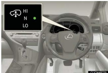
インジケーターが点灯し、選択中のモードを表示します。選択したモードへ移行中はインジケーターが点滅します。
