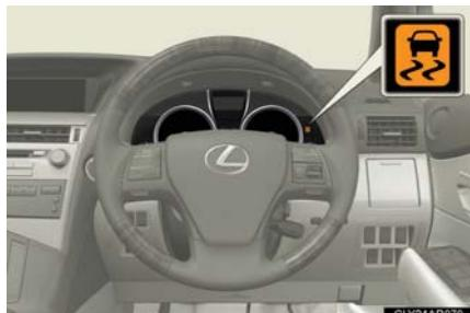
車が横すべりしそうになったとき、後輪が空転したとき・坂道発進をしたときは、VSC、TRC の作動を表示するために、スリップ表示灯が点滅します。
