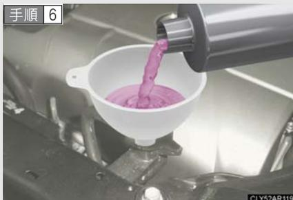
冷却水が不足している場合は、冷却水を補給する。
