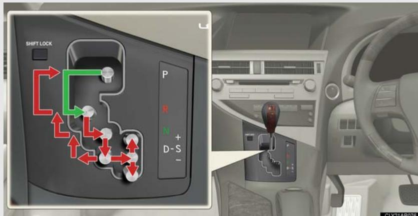
← “エンジン スタート ストップ”スイッチがイグニッショナONモードの状態で、ブレーキペダルを踏んだまま操作します。
