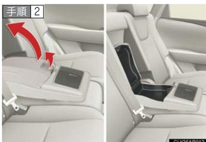
レバーを引き上げてロックを解除し、フタを持ち上げて開く
