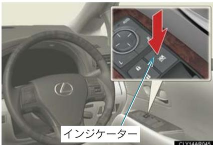
スイッチを押すと、インジケータが点灯し、運転席以外のドアガラスが作動不可になります。
