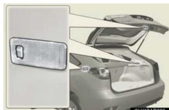
スイッチをONにしておくとバックドアを開けたとき、ラゲージルームライトが点灯します。
