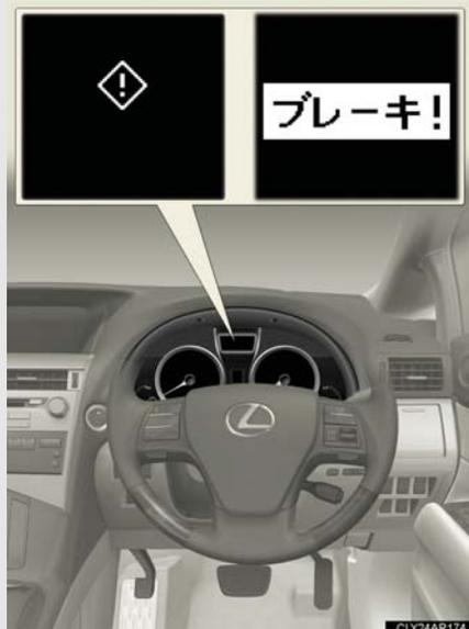
衝突の危険性があると検知したとき、“ピーピーピー”とブザー音が鳴り、PCS 警告灯が点滅し、マルチインフォメーションディスプレイに注意喚起表示が出ます。さらに衝突の可能性が高い場合には、“ピピピ…”とブザー音が鳴り、PCS 警告灯が点滅、衝突警告表示を出し、回避操作をうながします。
