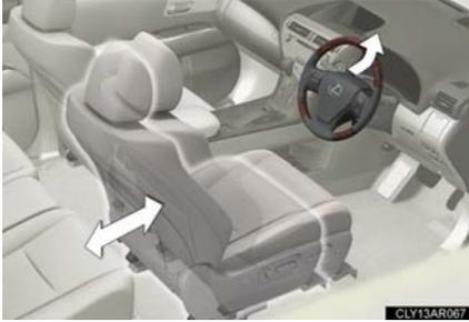
降車時：以下のすべての操作を行ったとき、ハンドルが最上段・最前方に移動、運転席シートが後方に移動（オートアウェイ機能）
