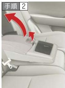
レバーを引き上げてロックを解除し、フタを持ち上げて開く
