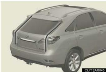
パワーバックドアの左右端部には、センサーがついています。ドアを自動で閉めているときに、挟み込みなどによりセンサーが押されると挟み込み防止機能が作動し、その位置からドアは自動的に反対方向に動き、全開位置で停止します。
