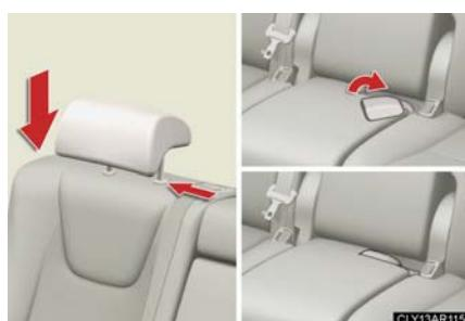
ヘッドレストとセンターシートのシートベルトバックルを格納する
