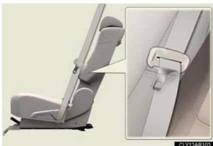
シートベルトをリヤシート側面のポケットに格納する
