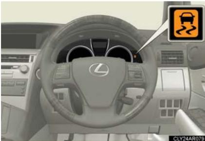
車が横すべりしそうになったとき、後輪が空転したとき・坂道発進をしたときは、VSC、TRC の作動を表示するために、スリップ表示灯が点滅します。
