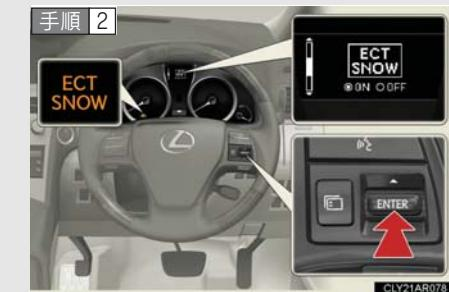
“ENTER”スイッチを押して、ONに切りかえると“ECT SNOW”表示灯が表示されます。
