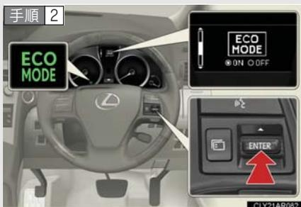
“ENTER” スイッチを押して、ONに切りかえると “ECO MODE” 表示灯が表示されます。
