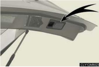
バックドアを引き下げるときにお使い下さい。バックドアハンドルを持ったまま直接バックドアを閉めないで下さい。
