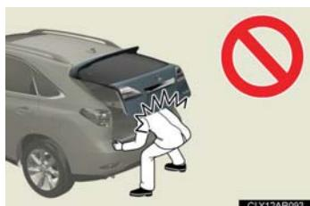
● 半開状態で使用すると、バックドアが落ちて重大な傷害を受けるおそれがあります。特に傾斜地では、平坦な場所よりもバックドアの開閉がしにくく、急にバックドアが開いたり閉じたりするおそれがあります。必ずバックドアが全開で静止していることを確認して使用してください。
