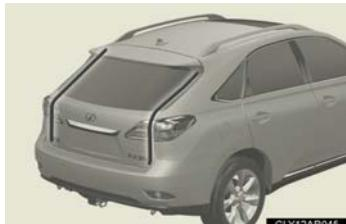
パワーバックドアの左右端部には、センサーがついています。ドアを自動で閉めているときに、挟み込みなどによりセンサーが押されると挟み込み防止機能が作動し、その位置からドアは自動的に反対方向に動き、全開位置で停止します。
