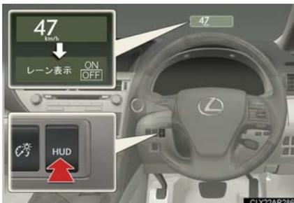
HUD メインスイッチを 2 秒以上押すと、レーン表示の ON/OFF 切りかえ画面に移行します。HUD メインスイッチを押すごとに ON/OFF は切りかわります。
