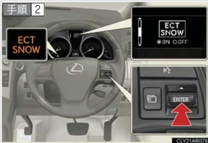
“ENTER” スイッチを押して、ONに切りかえると“ECT SNOW”表示灯が表示されます。
