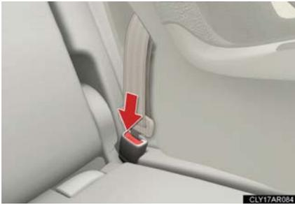
解除ボタンを押してバックルをはずし、ベルトをいっぱいまで巻き取らせると、チャイルドシート固定機構が解除されます。
