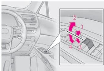
\*途中で停止するときは、スイッチを反対側へ操作します。
